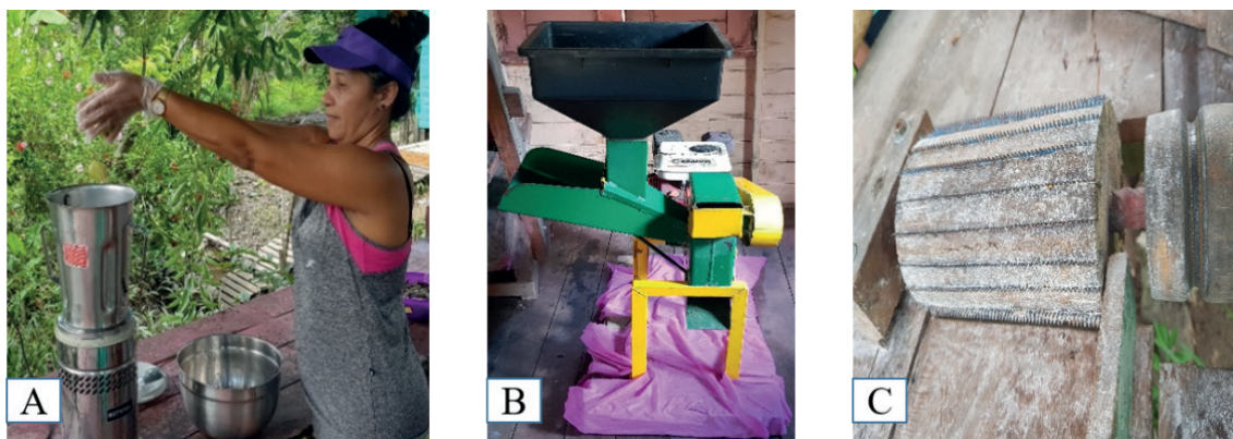
Figura 7. Processo de trituração das sementes de pracaxi secas praticado pelas Mulheres Extratoras da Comunidade do Limão do Curuá, Arquipélago do Bailique, Macapá – AP. A) Trituração de sementes por meio de liquidificador industrial; B) Triturador forrageiro usado para triturar as sementes; C) Triturador artesanal, conhecido como “catitu” que também é utilizado pelas extratoras.
